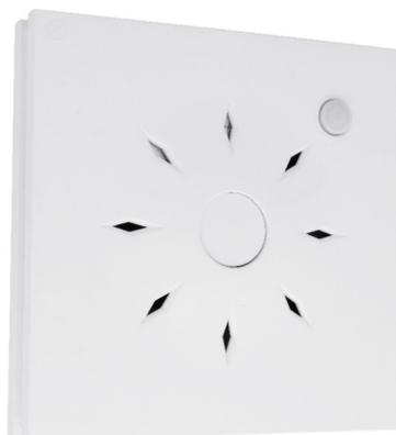
IXIA est une micro-station qui mesure le niveau de CO2 dans vos espaces intérieurs. Grâce à ses capteurs de température et d'humidité IXIA analyse votre air ambiant, de plus son module de communication sans fil rend ces données accessibles à distance.
